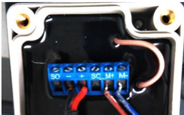
Rys. 36 Schemat podłączenia kabli w sterowniku Pergola DC (wykonuje fabrycznie firma SELT)
